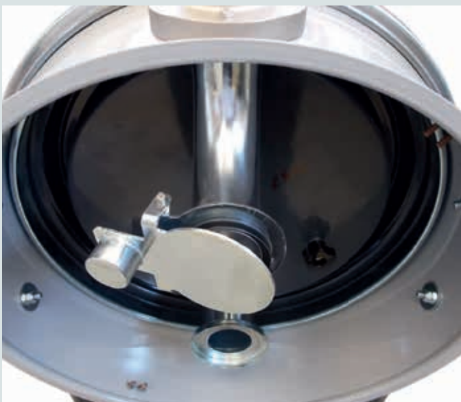
Deflektor mit Metallkappe. Schließt während des Entleervorgangs.
