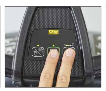
7. Bei empfindlichen Böden kann die Bürste/ das Pad vor dem Beginn der Arbeit mit der Reinigungslösung angefeuchtet werden, um Einbrennflecken zu vermeiden. Die Einschalttaste und die Taste für die Reinigungslösung gleichzeitig 10 bis 20 Sekunden lang gedrückt halten, bevor mit der Arbeit begonnen wird.
