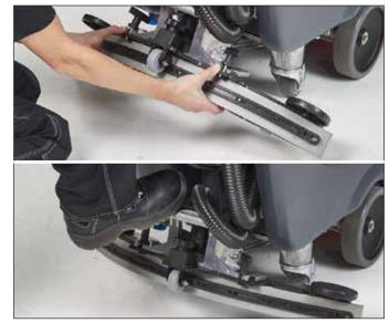
3. Die Saugleiste einlegen und mit den Stellschrauben befestigen. Pedal treten, um die Saugleiste abzusenken.
