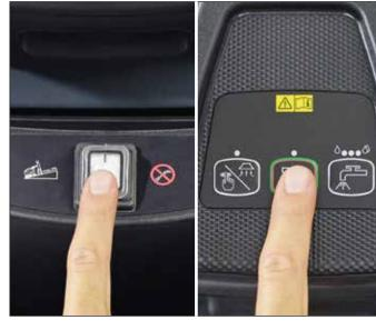
6. Um die Maschine einzuschalten, den Hauptschalter auf "I" stellen und die Haupttaste drücken (LED an).
