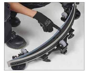
16. Die Saugleiste abnehmen und groben Schmutz entfernen. Die Saugleisten kontrollieren und reinigen.
