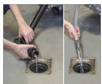
13. Den Schmutzwassertank mit dem Schlauch entleeren. Dann den Frischwassertank mit dem transparenten Schlauch entleeren
