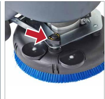
1. Um die Richtung der Maschine einzustellen, den vorderen Knopf drehen, bis die Maschine gerade läuft.
