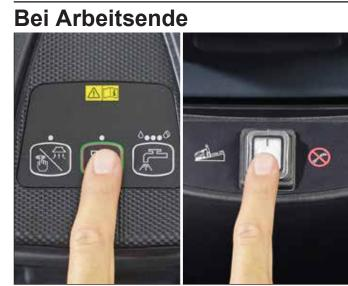
10. Die Einschalttaste erneut drücken, um die Funktionen abzuschalten (LED aus), den Hauptschalter auf "0" stellen. Entfernen Sie den Stecker aus der Steckdose.
