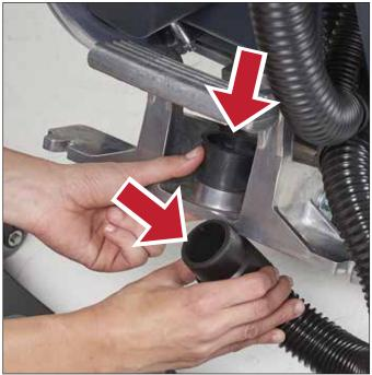
Prüfen Sie, ob der Saugschlauch richtig 2. Den Schmutzwassertank öffnen und installiert und gereinigt ist. kontrollieren, ob Grobschmutzfilter und geneinigt ist.
