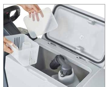
14. Den Grobschmutzbehälter entleeren und abspülen und den Schmutzwassertank reinigen/ ausspülen.
