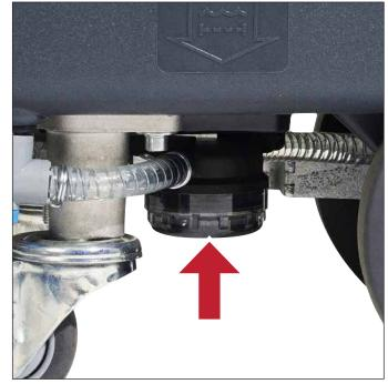
3. Prüfen Sie, ob der Filter frei von Verunreinigungen ist und entfernen diese bei Bedarf.
