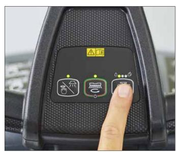
9. Die Taste für die Frischwassermenge drücken, um den Durchfluss an den Grad der Verschmutzung anzupassen. Wenn die LEDs aus sind, ist der Durchfluss ausgeschaltet.
