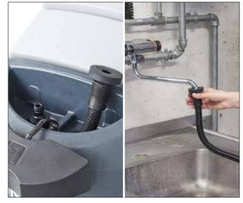
1. Den Tank mit sauberem Wasser füllen und gemäß der Anleitung ein geeignetes Reinigungsmittel hinzugeben. Die Temperatur des Wassers darf höchstens 40 °C betragen.
