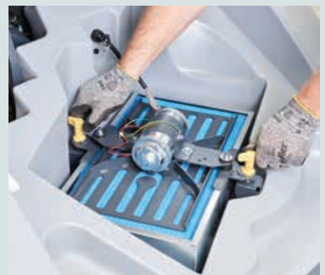
Filterrüttler der neuesten Technologie mit variabler Frequenz.
