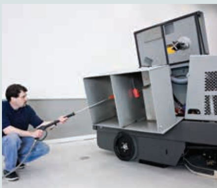
Kippbarer Schmutzwassertank für einfache Reinigung.
