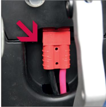
1. Überprüfen Sie bitte, ob die Batteriesteck-Verbindung richtig angeschlossen ist.
