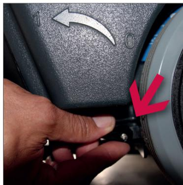
2. Prüfen Sie, ob der Reinigungsmittel-/Frischwasserventil geöffnet ist.
