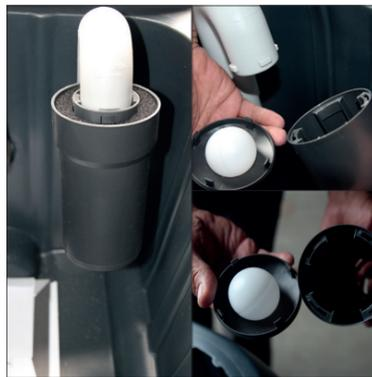
2. Öffnen Sie den Schmutzwassertank und prüfen Sie, ob das Sauggitter und die Dichtung sauber sind.
