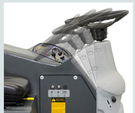
Kippbare Lenkeinheit für einfaches Einsteigen sowie ein ergonomisch gestalteter Fahrersitz für Sicherheit und Komfort.
