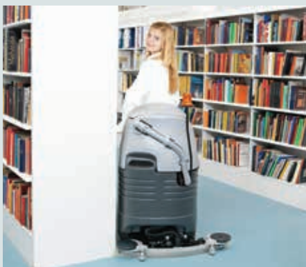
Das Schrubbdeck weicht seitlich aus, wenn es auf ein Hindernis trifft. Es folgt ganz genau der Wasserspur und garantiert so, dass das Wasser restlos aufgenommen wird, sogar in engen Kurven.
