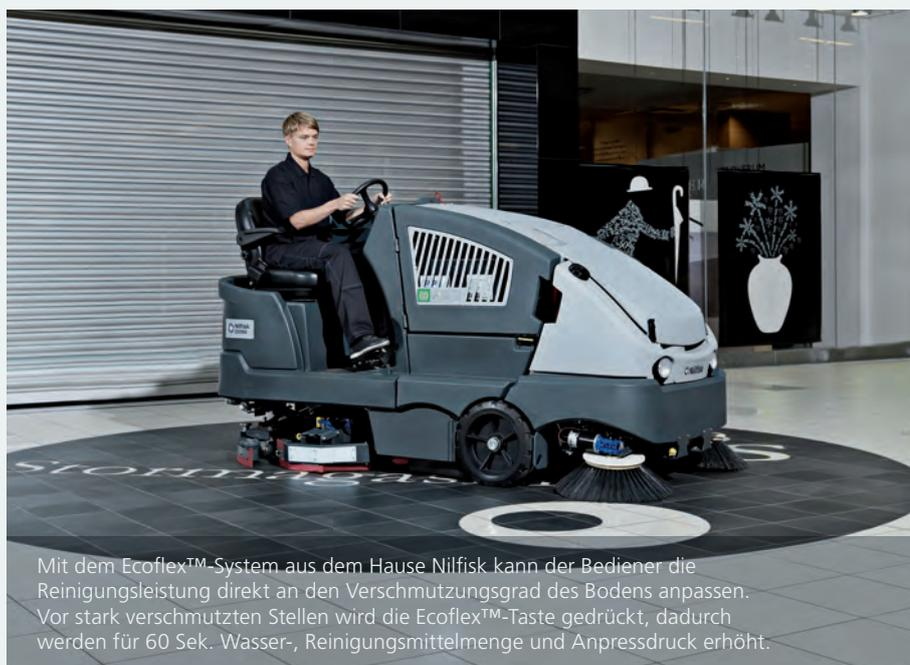
Mit dem Ecoflex™-System aus dem Hause Nilfisk kann der Bediener die Reinigungsleistung direkt an den Verschmutzungsgrad des Bodens anpassen. Vor stark verschmutzten Stellen wird die Ecoflex™-Taste gedrückt, dadurch werden für 60 Sek. Wasser-, Reinigungsmittelmenge und Anpressdruck erhöht.
