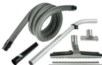
Industrie-Set 6teilig, Anschluss Ø 50 mm Saugschlauch 4 m, Universal Ø 50 mm; Verlängerungsrohr gebogen, eloxiertes Aluminium, 1000 mm; Industriebodendüse, Aluminium, 500 mm; Ersatz-Gummilippe, 370 mm; Fugendüse, Spezialkunststoff, 350 mm; Grobschmutzdüse, Aluminium, 200 mm
