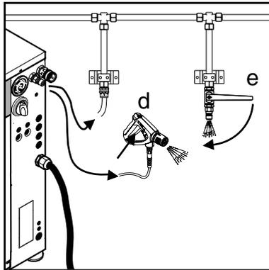
5. Das Wasser laufen lassen, bis die Luft aus der Pumpe ganz entwichen ist (gleichmäßiger Wasserstrom). Falls kein oder ein wenig Wasser aus dem System fließt, mag es notwendig sein, die interne Förderpumpe getrennt zu ent-
