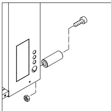
Die beigelegten Distanzbuchsen an der Rückseite des Gerätes montieren.
