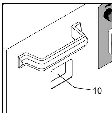
Falls der Motor der Maschine nicht anläuft, oder unbeabsichtigt stoppt, und die rote STOP-Taste (4) blinkt, ist ein Fehler beim System entstanden. Die Störungsanzeige am Display (10) ablesen und Abschnitt **7 Fehlersuche und Abhilfe** sehen.
