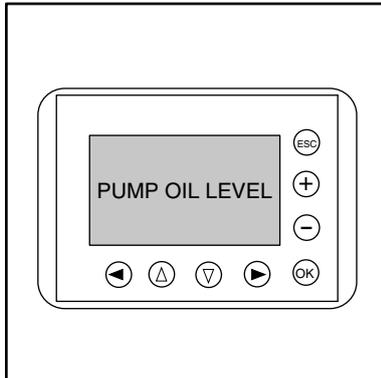
Ihre Maschine hat einen automatischen Ölstandssensor, der den Schmierölstand der Hochdruckpumpe überwacht. Falls der Ölstand (durch fehlerhafte Funktion oder Verschleiß) fallen sollte, wird die Maschine stoppen (oder nicht starten können) mit einer Störungsindikation "PUMP OIL LEVEL" am Display (10).
