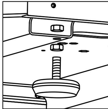
4 Füßer mit einer 19 mm Maulschlüssel am Flansch unter dem Gerät befestigen. Das Gerät auf einem ebenen Boden anbringen.
