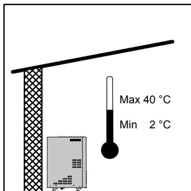
Das Gerät muss in einem frostfreien Raum aufgestellt werden. Dies gilt für sowohl Pumpe als auch Rohrleitung und Zapfstellen. Bei Außenzapfstellen muss es möglich sein, den Teil der Rohrleitung abzusperren und zu entleeren, der frostgefährdet ist.
