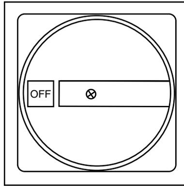
1. Die Anlage durch Ein-drücken der roten STOP-Taste (4) außer Betrieb setzen. Die rote Leuchte wird eingeschaltet. Um die Maschine völlig auszuschalten, den Hauptschalter (2) in Pos. "OFF" drehen.
