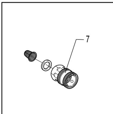
Am Wassereinlass ist ein Wasserfilter (fein) montiert, das das Eindringen von Schmutzpartikeln in die Pumpe verhindern soll. Abhängig von der Reinheit des Wassers ist dieses Filter gelegentlich zu reinigen. Das Filter lässt sich herausnehmen, wenn die Schnellkupplung (Pos. 7) abgeschraubt worden ist. Es gibt auch ein Filter (grob) im
