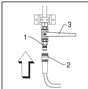
Bei Rohrsystemen mit fixen Zapfstellen den Hochdruckschlauch mittels einer Schnellkupplung (2) an den Hochdruckanschluss (1) des Hochdruckhahns anschließen. Nach dem Anschluss muss der Griff des Hochdruckhahns (3) in offene Position gedreht werden.
