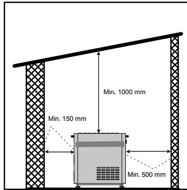
Gerätes muss es eine Abstand zur Wand an beiden Seiten des Gerätes sein. An der linken Seite mindestens 150 mm und an der rechten Seite mindestens 500 mm. Zur Decke muss die Abstand mindestens 1000 mm sein, und vom hinteren Punkt des Gerätes zur Rückwand muss die Abstand mindestens 100 mm sein. Andere Objekte müssen sich auch nicht in diesem Gebiet befinden wie zum Beispiel Rohre usw.
