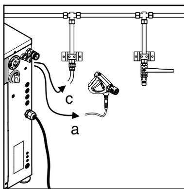
Den Hochdruckauslass des Gerätes (1) kann an einen serienmäßigen Hochdruckschlauch (a) oder an eine Rohrleitung mit fixen Zapfstellen (c) angeschlossen werden.
