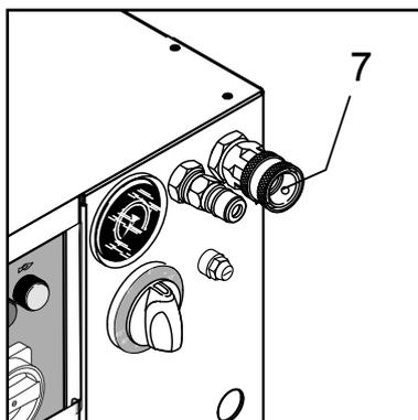
Der Wasseranschluss erfolgt über eine flexible Schlauchverbindung an der Schnellkupplung am Wassereinlass des Gerätes (7).
