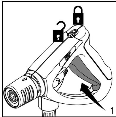
Die Maschine wird bei Betätigung der Spritzpistole (1) automatisch eingeschaltet. Wenn den Betätigungshebel der Spritzpistole losgelassen wird, schaltet die Anlage automatisch ab und steht somit Stand-by. Wird die Spritzpistole nicht innerhalb 20 Sek. betätigt, schaltet die Maschine zur Stand-by. Wenn der Reiniger nicht in Betrieb ist, ist die Spritzpistole durch Betätigung der Sperrklinke zu schließen.
