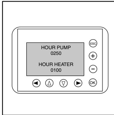
Ihre Maschine hat eingebaute Stundenzähler, die die Betriebsstunden des Gerätes steuern. Durch Eindrücken der roten STOP-Taste (4) und sie eingedrückt zu halten, lassen sich die Betriebsstunden der Pumpe und des Heizungssystems am Display (10) ablesen.
