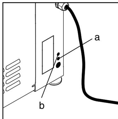
Alle D-Modelle müssen an eine externe Brennstoffversorgung (Behälter oder Tank) angeschlossen werden, da keinen Brennstofftank eingebaut worden ist.
