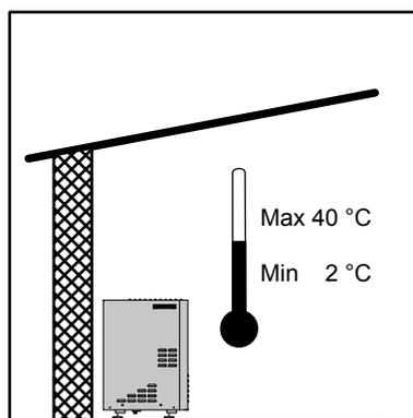
Die Anlage muss in einem frostfreien Raum aufgestellt werden. Dies gilt für sowohl Pumpe als auch Rohrleitung und Zapfstellen. Bei Zapfstellen draußen muss es möglich sein den Teil der Rohrleitung abzusperren und zu entleeren, der frostgefährdet ist.
