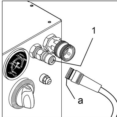
Den Nilfisk Hochdruckschlauch mittels einer Schnellkupplung (a) an den Hochdruckanschluss (1) des Gerätes anschließen. Max. Arbeitsdruck und Temperatur sind auf dem Hochdruckschlauch aufgedruckt.
