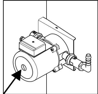
leitungssystemen, oder wenn die Rohrleitung und die Pumpe entleert gewesen sind, muß die Anlage dadurch entlüftet werden, die Pumpe in Betrieb zu setzen und das Wasser aus jeder Zapfstelle der Rohrleitung abwechselnd laufen zu lassen. Es empfiehlt sich, bei der entferntesten Zapfstelle anzufangen (Höhe und/oder Länge).
