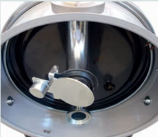
Deflektor mit Metallkappe. Schließt während des Entleervorgangs.
