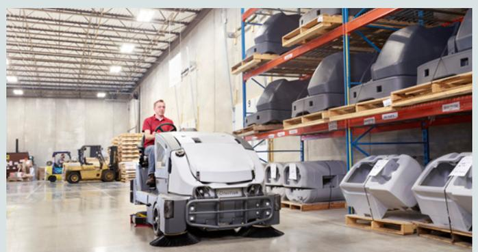
Das SmartFlow™-System passt den Lösungsfluss an die Geschwindigkeit der Maschine an. Dadurch entsteht höhere Produktivität bei weniger Entleerungs- und Nachfüllzyklen pro Tank.
