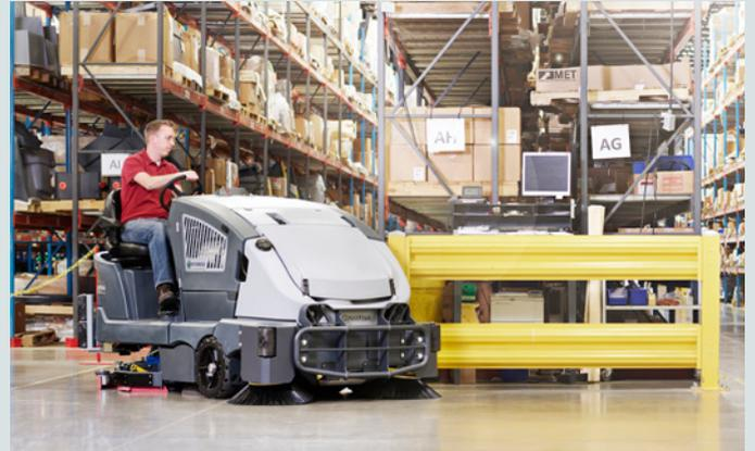
Automatische Geschwindigkeitsverringering in Kurven für mehr Sicherheit.
