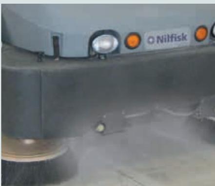
Das DustGuard™-System kontrolliert aufgewirbelten Staub durch Abgabe eines feinen Sprühnebels.
