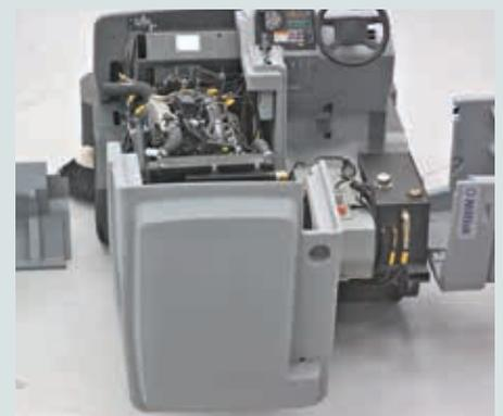
Durch das Nilfisk MaxAccess™-System werden Wartungsarbeiten schnell und einfach. Ein Zugang von fünf Seiten zu allen Maschinen- und Hydraulik-Komponenten ermöglicht Ihnen Zeit zu sparen und Service-Kosten zu reduzieren.
