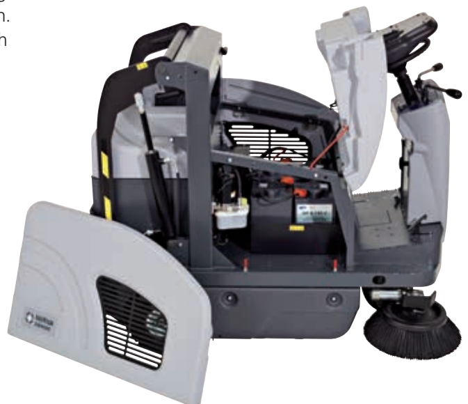
MaxAccess™ – Rundum guter Zugang zu allen Komponenten und werkzeugfreier, schneller Wechsel von Bürsten und Walze.
