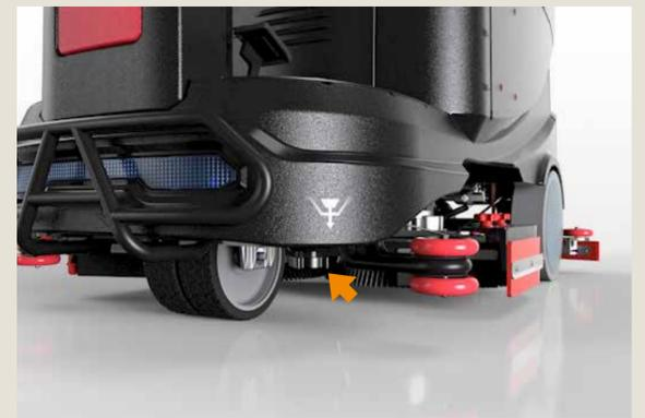
Den Frischwassertank entleeren. Filter (wöchentlich) prüfen und reinigen.
