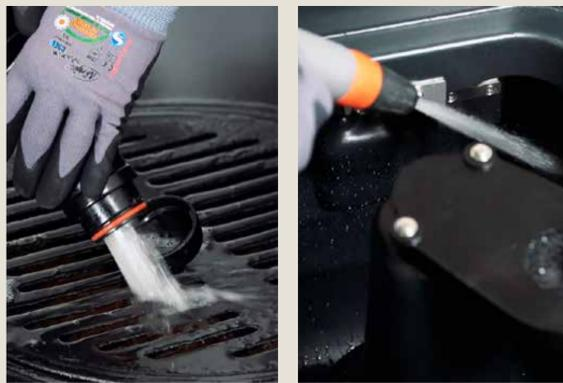
Den Tank mit dem Schlauch an der Rückseite entleeren. Das Grobschmutzsieb im Schmutzwassertank leeren und reinigen. Den Schmutzwassertank mit frischem Wasser spülen und reinigen.
