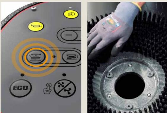
Den Schlüssel auf „I“ (AN) stellen und die Taste für den Bürsten-/Padabwurf drücken, um die Bürsten-/Padhalter zur Wartung und Reinigung aus der Halterung zu lösen.
