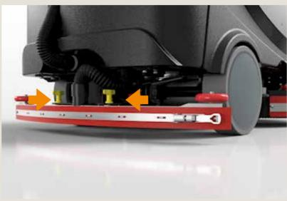
Die Saugleiste aufstecken und mit den beiden Stellschrauben befestigen.
