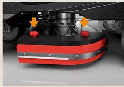
Beide Drehknöpfe lockern, um die Seitenleiste zu entfernen.
