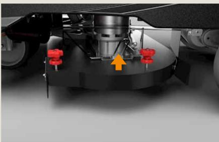
Zum Installieren von Bürste-/Padhalter den Metallgriff hochziehen und den Bürsten-/Padhalter einschieben, bis er in der richtigen Position an die Stifte anstößt. Den Griff loslassen. Die Seitenleiste wieder befestigen.
