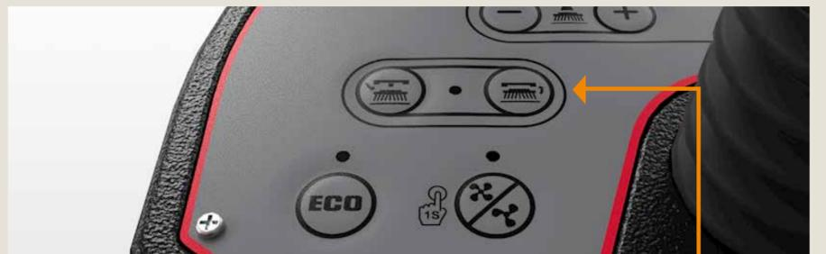
Den Hauptschlüssel auf „I“ (AN) stellen und die Taste für die automatische Bürstenaufnahme drücken. Das Deck wird gesenkt und die Bürsten drehen sich langsam fest.
