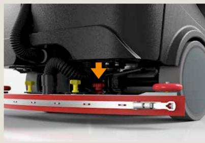
Mithilfe der Stellschraube an der Halterung können Sie den Winkel und Druck der Saugleiste für eine optimale Schmutzwasseraufnahme einstellen.
