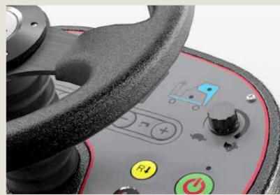
Drücken Sie die entsprechenden Tasten, um die Reinigungseinstellungen vom Bedienfeld aus zu ändern.
