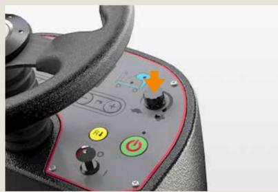
Die Maximalgeschwindigkeit am Geschwindigkeitsregler einstellen.
