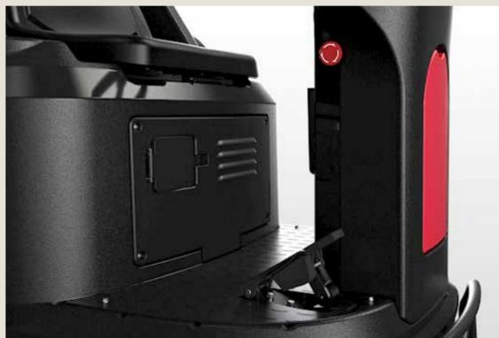
Das Batterieladegerät in die Buchse an der Maschine stecken und das Ladegerät einschalten.
