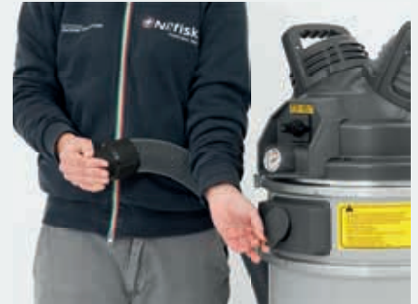
PullClean Filterabreinigungssystem: Einfach den Einlass des Saugers verschließen und mehrmals kurz die Nebenluftklappe betätigen.
