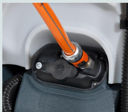
Optionales Befüllsystem mit automatischer Abschaltung.
