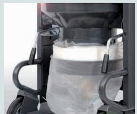
**Entsorgung:** Die Entleerung des S2 erfolgt über einen 40-Liter Behälter, die Entleerung des S3 über einen 50- oder 100-Liter Behälter. Beide können alternativ mit einem Longopac®-Entsorgungssystem (Endlos-Plasticsack) ausgestattet werden.
