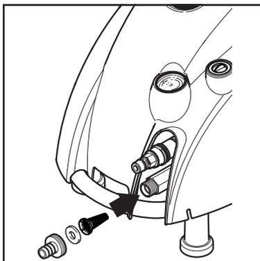
Am Wassereinlaß ist ein Wasserfilter montiert, welches das Eindringen von groben Schmutzpartikeln in die Pumpe verhindern soll.
