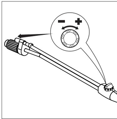
1. Drehknopf an der Spritzeinrichtung drehen:
