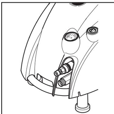
1. Zur Ölstandskontrolle Deckel abnehmen. Das Gerät muss auf einer ebenen Unterlage stehen, dann ist das Öl gerade noch sichtbar. Falls erforderlich, Öl nachfüllen (Ölsorte, siehe auch Kapitel 9.4)
