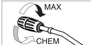
1. Hülse der FlexoPowerJet-Düse drehen:
