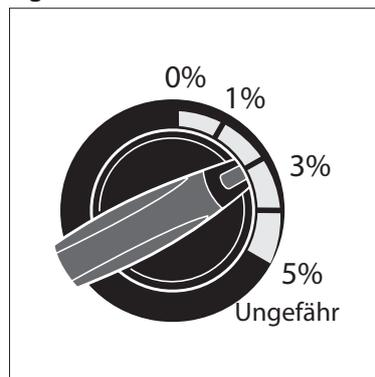
Nur im Niederdruckbetrieb können Reinigungsmittel über den serienmäßig eingebauten Injektor angesaugt werden:
