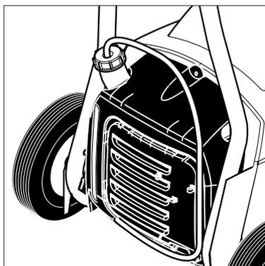
1. Reinigungsmitteltank mit Nilfisk-Alto-Reinigungsmittel füllen. Füllmenge siehe Kapitel 9.4 Technische Daten.
