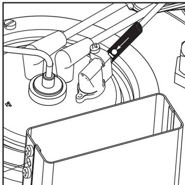
1. Den Sensor herausnehmen und mit einem weichen Tuch reinigen
