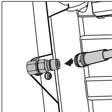
1. Hochdruckschlauch mit Schnellkupplung am Hochdruckanschluss des Gerätes anschließen.
