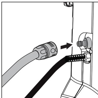
1. Den Wasserschlauch vor dem Anschluss an das Gerät kurz mit Wasser spülen, damit Sand und andere Schmutzteilchen nicht in das Gerät gelangen können.
