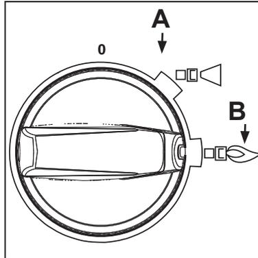
1. Hauptschalter in Stellung Kaltwasser (A) bringen. Die Steuerelektronik führt einen Selbsttest durch, alle LEDs leuchten einmal auf. Der Motor startet.
