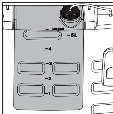
1. Reinigungsmitteltank<sup>1)</sup> mit Nilfisk-Reinigungsmittel füllen.
