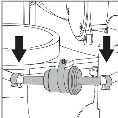
1. Schlauchclips öffnen
